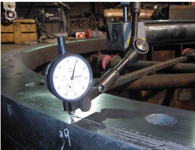
Fuente: P5233039.JPG Revisión de la planitud
